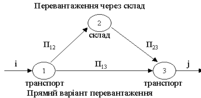
Рисунок 3.1 – Поточковий граф перевалки вантажу: \Pi_{12}, \Pi_{23}, \Pi_{13} – переробна здатність вантажних фронтів.
