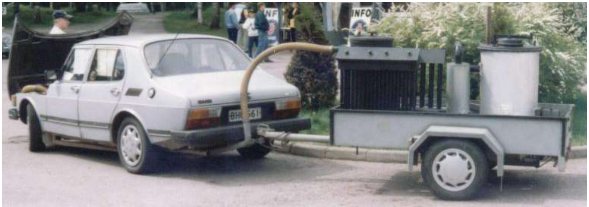
Рисунок 40 – Автомобіль Saab 99 працює на деревному газі. Газогенератор розташовано на причепі
