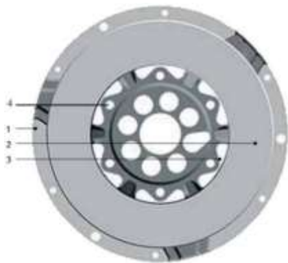
Рисунок 20 – Двомасовий маховик – вторинна маса
