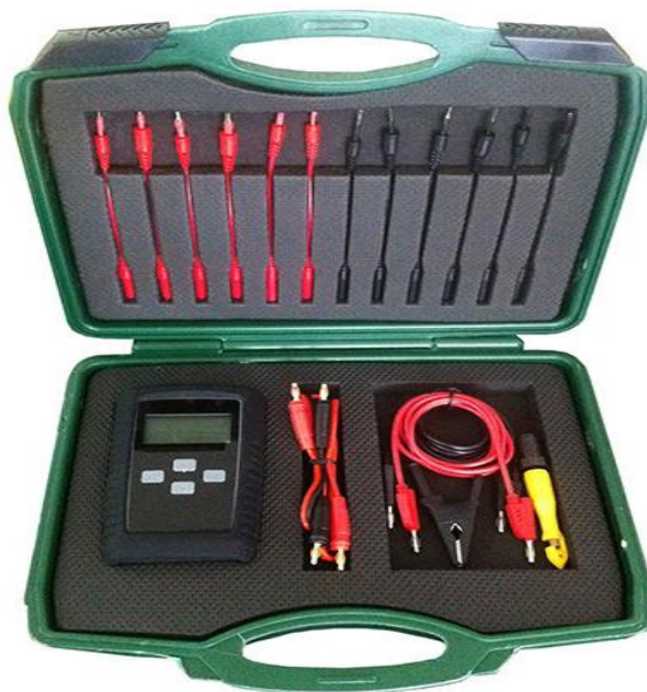
Рисунок 10 – Тестер-імітатор датчиків ADD71 може бути використаний на будь-яких автомобілях з електронними системами управління
